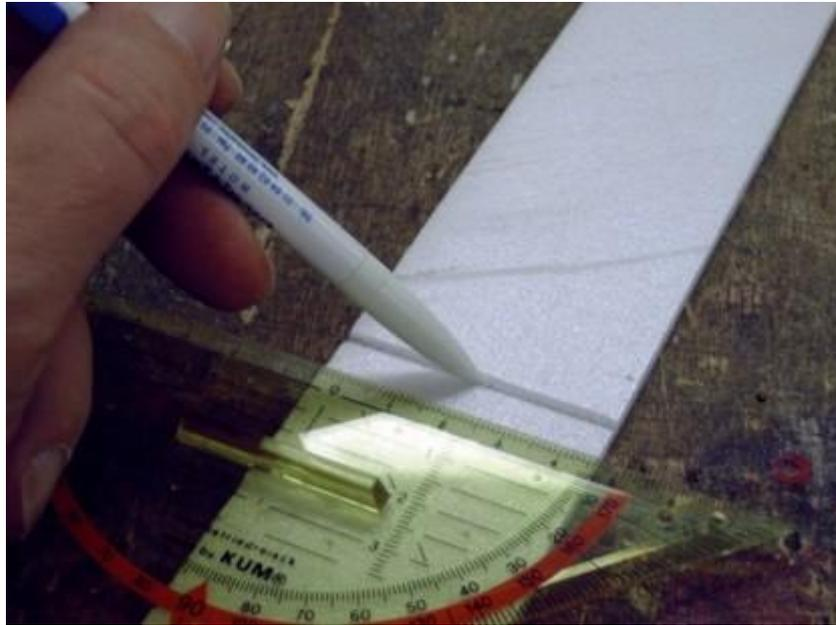
Zusätzlich bekommen die Seitenwände je zwei Führungsschienen aus 5mm breiten Depronstreifen aufgeklebt. Darin läuft später der Kabinendeckel. Bei aufkleben hilft ein 3mm-Abfallstück, den richtigen Abstand einzustellen.
